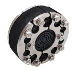
gegen nicht drückendes Wasser bestehend aus 1 x 30 mm starken Gummiplatten in EPDM 45 Shore, zwischen mind. 4 mm starken Edelstahlblech V2a mit Edelstahlschrauben ähnlich der DIN 603 mit M6, M8 oder M10 verschraubt und Sechskantmuttern in V4a.
